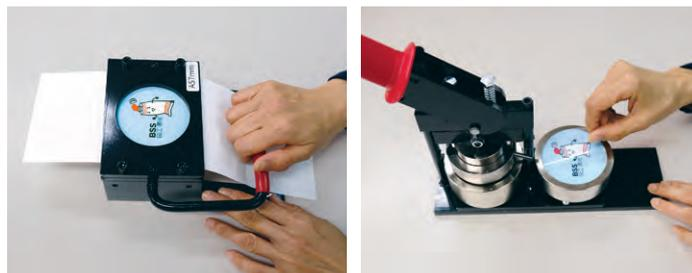
1. デザインした用紙をカッターで丸く抜きます。 2. 缶バッジ・デザインした紙・フィルム、安全ピンをマシン土台にセットします。
