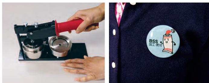
3. 缶バッジをプレスしたら、土台を回転させ、完成！安全ピンにプレスします。
