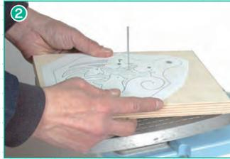
② 糸のこの刃を下部止金具にセットしたら、刃穴に通します。
