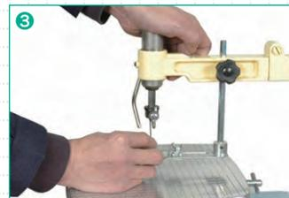
③ 上部止金具を緩ませ、のこ刃をくわえる部分を広げます。押し下げノブをぐっと下まで押し下げながら、のこ刃を上部止金具に差し込みます。
