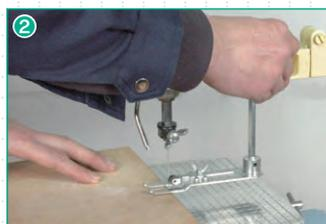
② 板押さえをおろし、ねじを締めて固定します。
