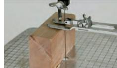
機種にもよりますが、学校で多く使われている糸のこ機械のストローク幅は15mmと狭く、また上部吊上げ金具が上下するため、厚いものを切るには不向きです。
