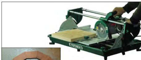
傾斜角度0°でのレンガの切断
