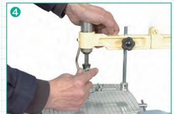
④ 押し下げノブを押し下げたまま、上部止金具のねじを締め、のこ刃を固定します。
