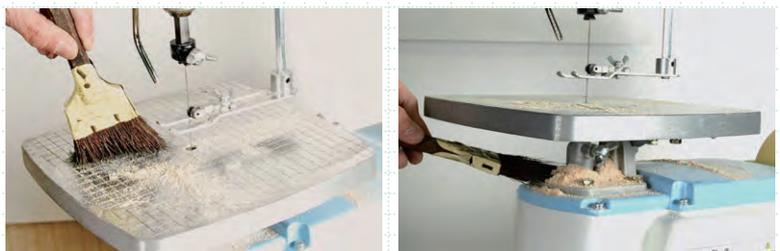
テーブル上と、テーブル下の下部止金具周辺の切りくずを刷毛や布などで掃除しましょう。また、エアーポンプが付いている糸のこは、糸のこ台周辺の床まで切りくずが吹き飛ぶので、床も掃いておきましょう。床に切りくずが落ちていると滑りやすくなって危険です!
