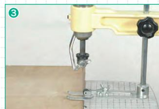
③ 作業中、板押さえをしていても、どうしても板が跳ね上がる場合は、板押さえを上から軽く押し、材料にあてて固定します。
