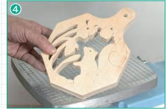
④ 切り抜き終わったら、押し下げノブを押さながらねじをゆるめてのこ刃をはずし、切り抜いた材を取りはずします。
