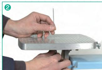
② テーブル下の、下部止金具にのこ刃を差し込み、ねじを締めて固定します。ねじ締めが緩いと作業中にのこ刃が外れるので、しっかりねじを締めてください。
