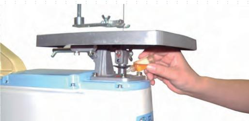
糸のこ機械を使う前と後に、動力ロットにマシン油をさしておく、動きがスムーズになるだけでなく、動力部の焼き付きなどを防ぐことができます。マシン油をさしたら、電源を入れて数回動かし、マシン油を浸透させます。
