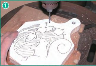
① 中抜きしたい部分に、のこ刃が通る刃穴をドリルであけます。刃穴はのこ刃が通りやすいよう、のこ刃より大きな穴にします。
