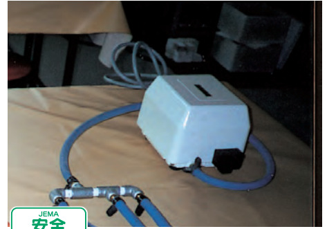
エアポンプ P-19B 型と三つ又の接続使用例
