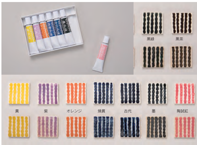
呉須7色セットの焼成色見本(上段は酸化、下段は還元)
