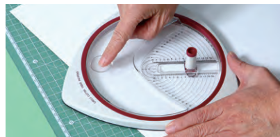
②回転部のPUSHボタンに指先を入れ、回転させてカットする
