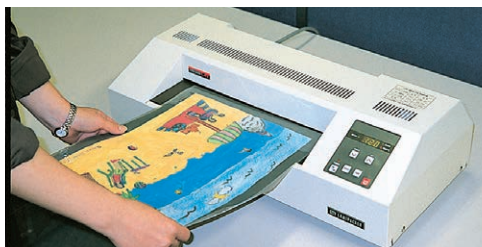
② ラミネート機にかけて熱する。
