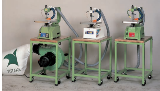
UF-01型1台で最大3台の糸のこ機械の集塵ができます。
