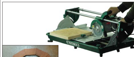
傾斜角度0°でのレンガの切断
