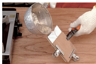
⑤鑄込む 紙型の両面をペニヤ板で強く挟み込み、メタルが冷めないように手早く流し込みます。
