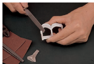
⑧仕上げる 金工やすりでバリを取り、紙やすりなどで表面や光沢の処理をして完成です。
