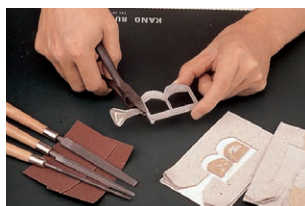
⑦整形する 出来上がったメタルを取り出し、ニッパーで湯道部分を切り取ります。
