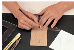
①デザインする 鑄型になる黄ボール紙に溶けたメタルの流れる通筋をよく考えて作図する。
