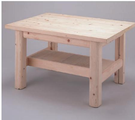
総枠造りの陶芸作業台です。天板は厚さ40mm、脚部は100mm角の頑丈な台で、天板は塗装を施さずに水分を吸収しやすく粘土なども付着し難く、陶芸作品づくりの作業には最適です。天板の高さも2種にして身長との兼ね合いを配慮してあります。
